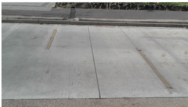
Rysunek 1. Rozmieszczenie czujników tensometrycznych na stanowisku ITS
