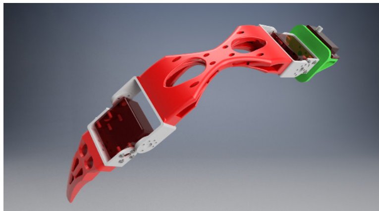
Rysunek 4. Model CAD kończyny Biobota Pająka: czerwone-ramiona, zielony-łącznik, czarne-serwomechanizmy, szare-mocowanie serwa [źródło własne]
