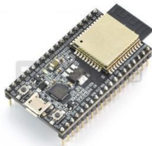
Rysunek 2. Moduł ESP-WROOM-32 [7]
