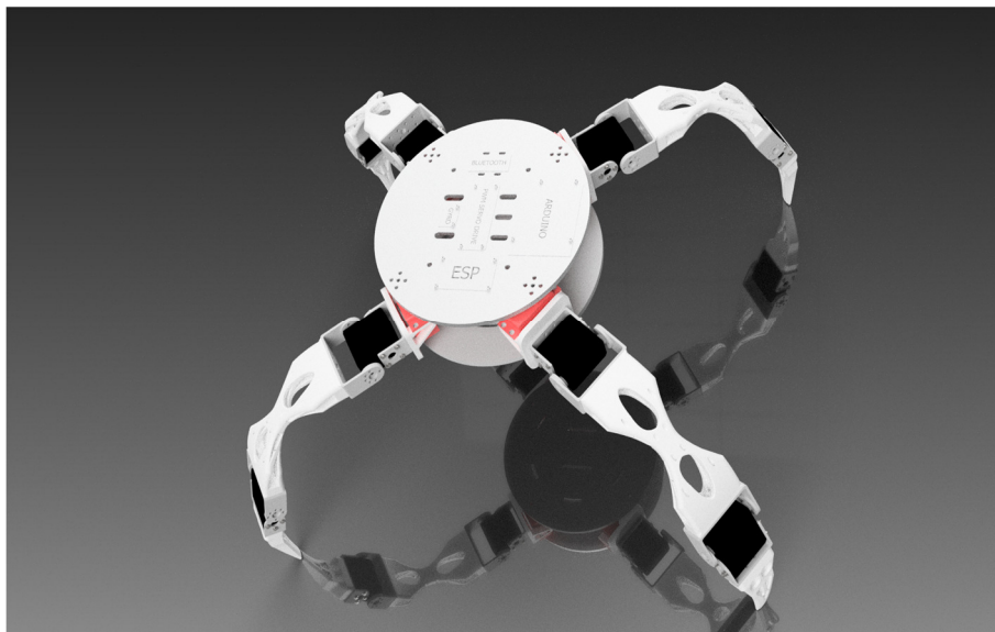
Rysunek 5. Model CAD Biobiota Pająka. [źródło własne]
