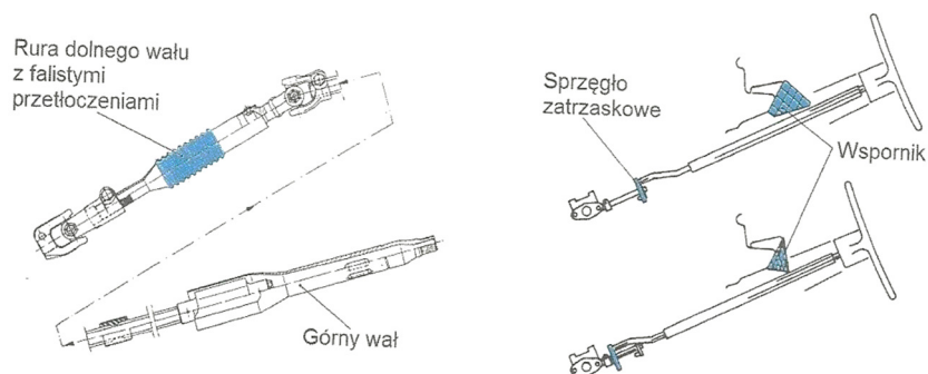
Rysunek 1. Mechanizmy energochłonne w postaci rury z falistymi przetłoczeniami (z lewej), oraz ze sprzęgłem zatraskowym (z prawej). [4,7]
