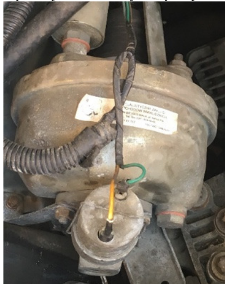
Rysunek 1. Siłownik odpowiedzialny za pracę sprzęgła w przystosowanym pojeździe dla osoby z problemami z lewą nogą
