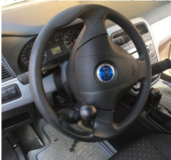
Rysunek 3. System ręcznego sterowania sprzęgłem, pedałem hamulca oraz przyspieszenia zamontowany w pojeździe FIAT Grande Punto
