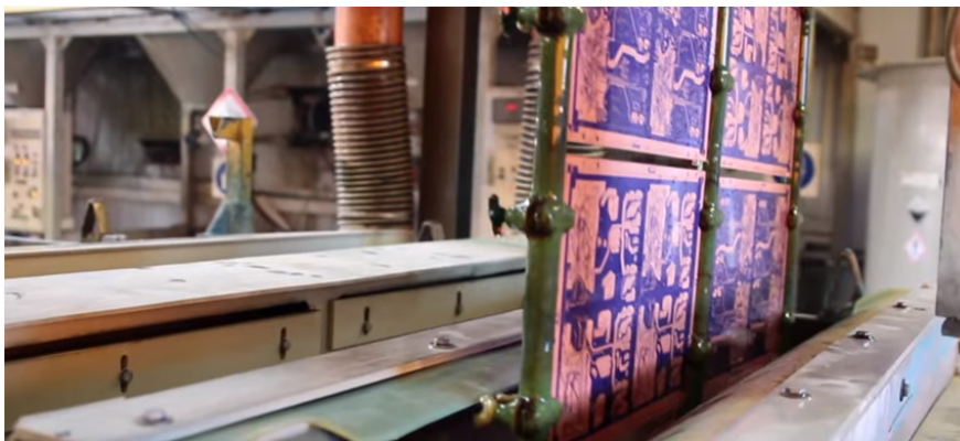
Rysunek 2. Metalizowaniu wykonanych uprzednio otworów na automatycznej linii galwanicznej [4]
