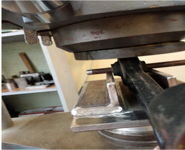
Rysunek 4. Przebieg jednej z prób obciążeniowych tulei
