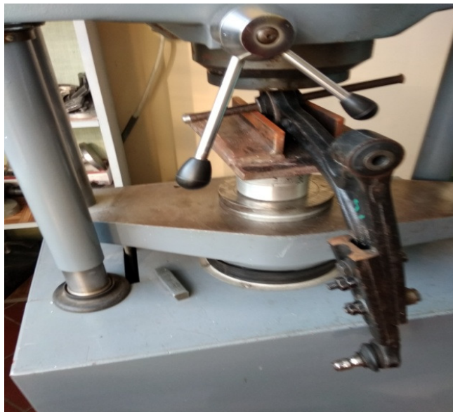
Rysunek 5. Przebieg jednego z pomiarów podatności kątowej na ceowniku z obniżoną ścianką
