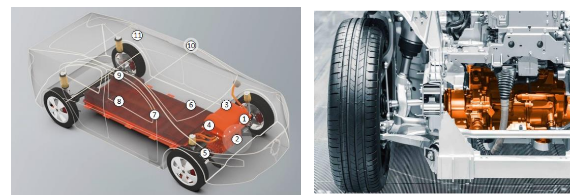
Montaż układu przeniesienia napędu (kolor pomarańczowy) [9]
