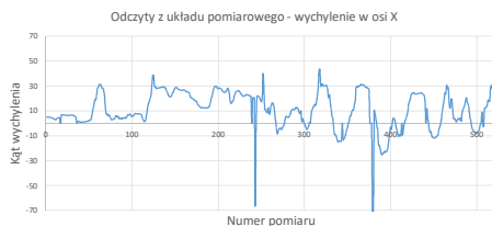
Rys. 8 Odczyty z układu pomiarowego - wychylenia w osi X
