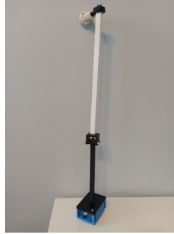
Rys. 2 Wahadlo drugiego stopnia z przykręconym czujnikiem TMM88-PCI090
