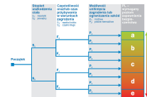
Rys. 2. Graf ryzyka na podstawie Normy EN ISO 13849
