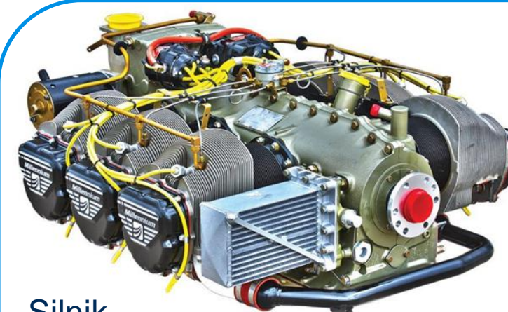
Silnik Continental TSIO-520-M Rok prod. : 1980r. TT: 7638,8 FH, TSO: 1766,9 FH;
